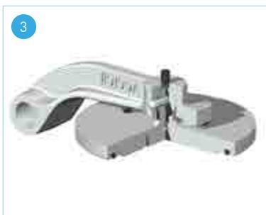
Die kugelförmigen Lagerzapfen ermöglichen eine Selbstzentrierung des Ventiltellers im Gehäusesitz [3], was zu einer dauerhaft anpassungsfähigen Dichtung führt. Dadurch wird eine präzise und störungsfreie Funktion des Rückschlagventils auch bei geringem Gegendruck gewährleistet.
